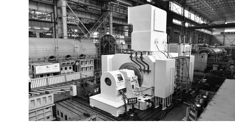
国内首台容量最大的新型凸极空冷分布式调相机
