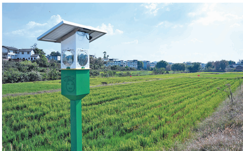
田间安装的风吸式物联网杀虫灯。中铁科研院供图
