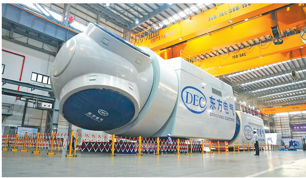
18兆瓦直驱海上风电机组。
