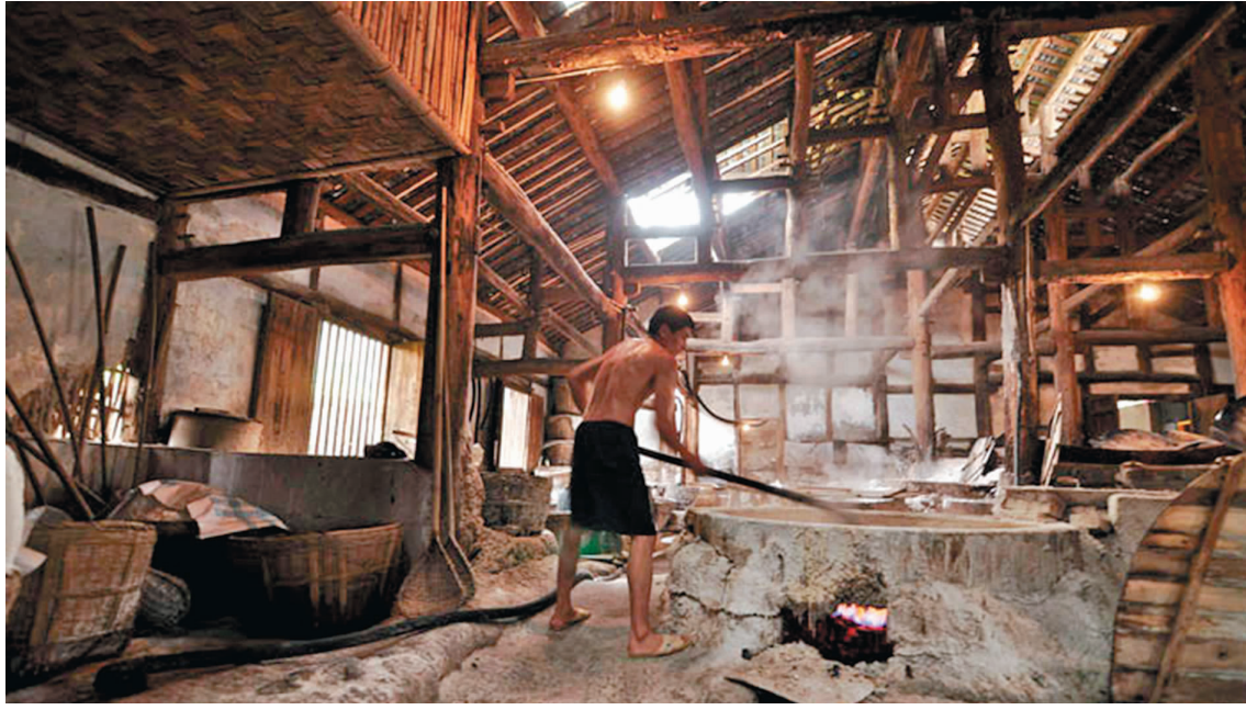
工人在灶房熬制井盐。
