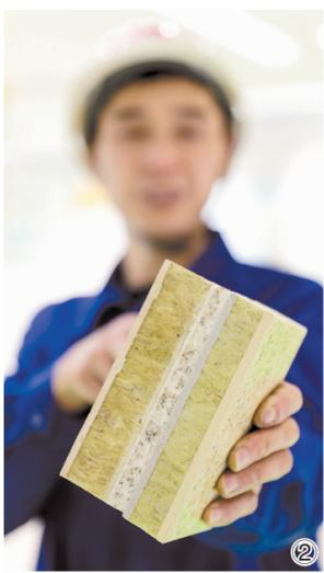
近日，广安华蓥市一民营企业引进世界先进的矿物纤维生产技术，对华蓥境内丰富的玄武岩、白云石等石资源实施生态保护性综合开发利用，制作新型节能建筑保温隔热、吸音降噪、阻燃的矿物纤维产品。
