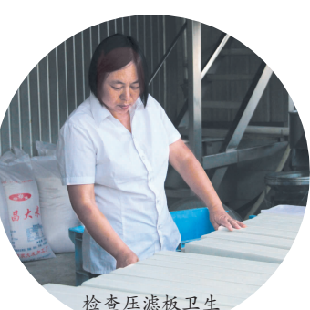
检查压滤板卫生
