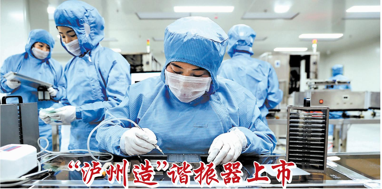
近日，泸州市纳溪区明德亨科技石英晶体谐振器智能生产线车间内的工人正在进行喷胶、封焊作业。
