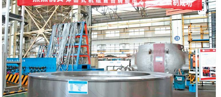
500兆瓦冲击式水电机组转轮中心体锻件。(东方电气集团东方电机有限公司供图)
