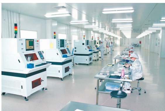
工人正在生产功率半导体器件——切片。
