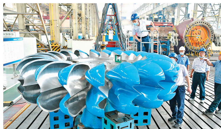
首台国产化150兆瓦级大型冲击式转轮静平衡(东方电气供图)
