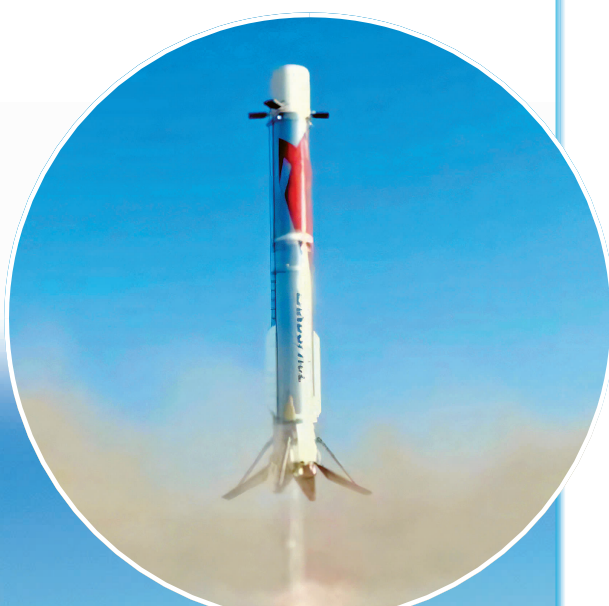
8月19日,视频截图显示朱雀三号遥二运载火箭一子级在着陆过程中展开着陆支腿,正在着陆。 新华社发(蓝箭航天供图)
