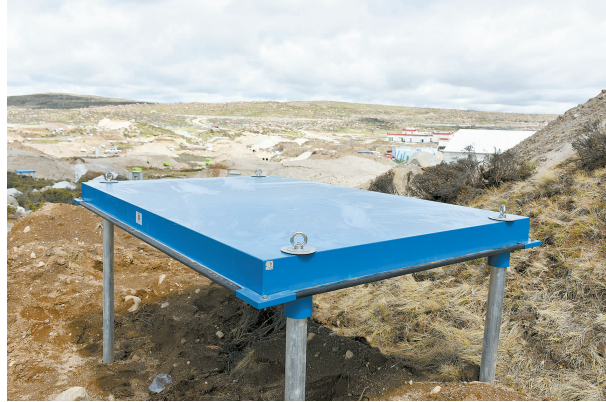
电磁粒子探测器(ED)
